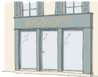
coffrage en applique
